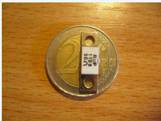
При очень скромном размере резистор способен держать солиную мощность в 100Вт. На фото резистор в сравнении с монетой достоинством в 2 Евро.
