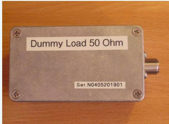
Наносим термопасту, монтируем в металлический корпус и получаем мощную нагрузку на всю оставшуюся жизнь.
